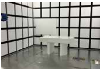
EMC 試験設備 製品の電磁波耐性や発生する電磁波を評価するため、EMC (Electromagnetic Compatibility) 試験機器と電波暗室を設置
