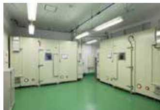
大型環境試験室 屋内外のさまざまな使用環境を想定し、温度-30～+80℃、湿度10～95%の試験が可能な環境試験室を2基設置
