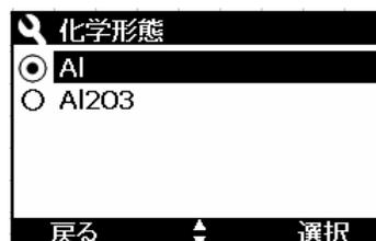
測定表示に戻ります。表示には、選択した化学形態が反映されます。
