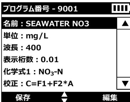
プログラム名、単位、測定波長、濃度表示桁、化学式、検量線、測定上限値、測定下限値、タイマーおよび表示化学式を編集できます。
