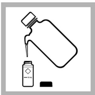
**17. 測定後は、直ちにサンプルセルをきれいに洗浄し、精製水で 3 回以上すすいでください。**
