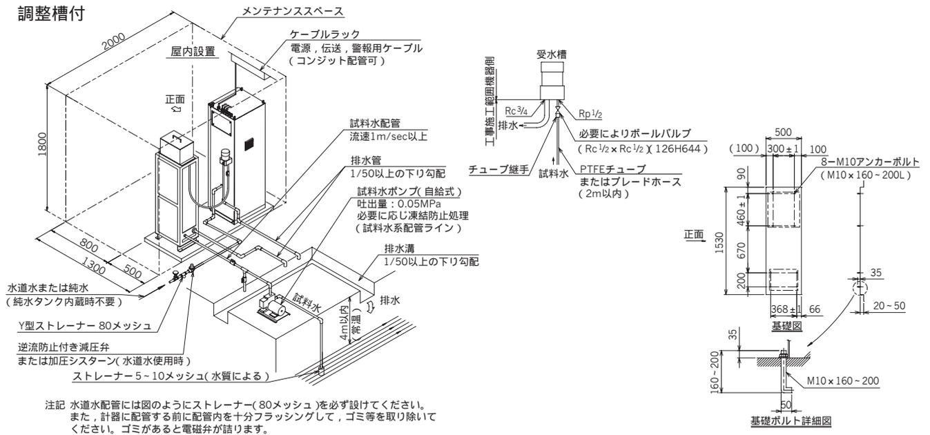
注記 水道水配管には図のようにストレーナー(80メッシュ)を必ず設けてください。また、計器に配管する前に配管内を十分フラッシングして、ゴミ等を取り除いてください。ゴミがあると電磁弁が詰ります。
