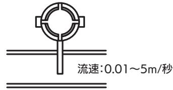
図A 水平配管・垂直取り付け
