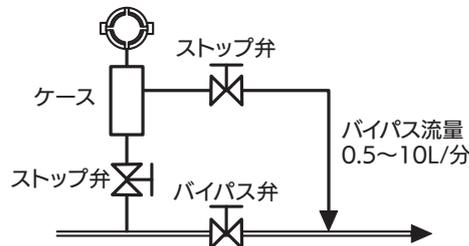
図D 流液型バイパス配管取り付け
