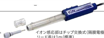
イオン感応部はチップ交換式 (隔膜電極除く)
