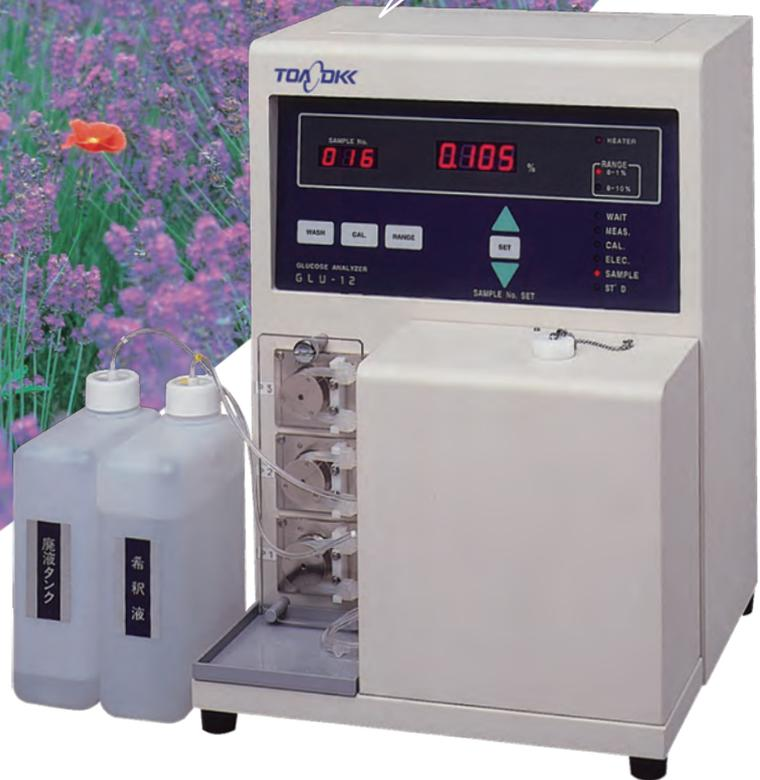
GLU-12は、発酵、食品、酒造、および医薬品工業等において重要なグルコース濃度の測定を迅速、簡便に行います。臨床検査分野で実績のある酵素膜センサを使用しており、長期間使用できます。サンプルを注入するだけで、測定は約1分間で完了します。洗浄などの操作はもとより、校正や測定値の演算もすべて自動的に行われ、正確で、再現性のある測定値が迅速に得られます。
