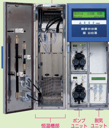
メインユニット構成例 (2ch分析システム) 電気伝導率検出ユニット (背面装着)
