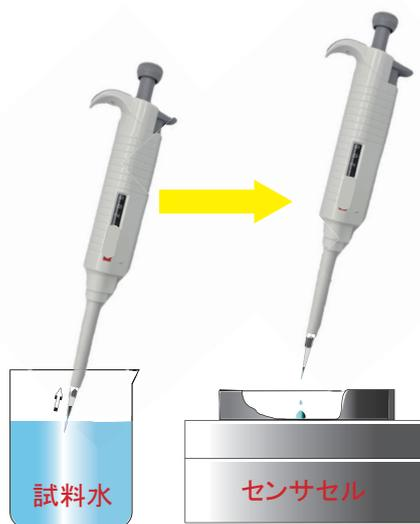
測定は試料水をセンサーセルに滴下するだけ
