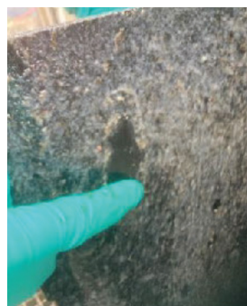
写真2: 放流水監視で発生したスライム付着例
