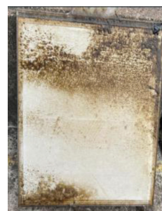
写真6: 16週間運転後のFX620フィルター膜(機械的洗浄なし)
