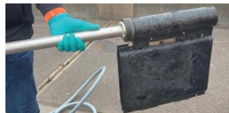
写真3: FX620ろ過モジュール
