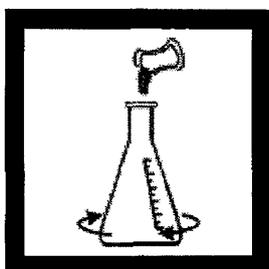
5. 塩化物 2 指示薬パウダーピロー1 包を加え、攪拌して混合して下さい。
