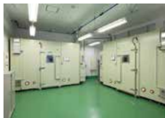
大型環境試験室
