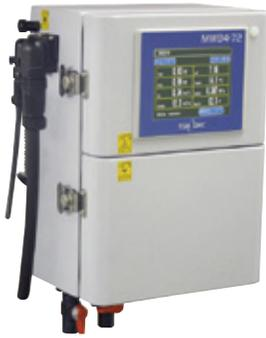
安全でおいしい水道水に必要な7つの検査項目を自動計測する装置で水道管路のいたるところに設置されている
