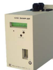
アンモニア ガス検知器
