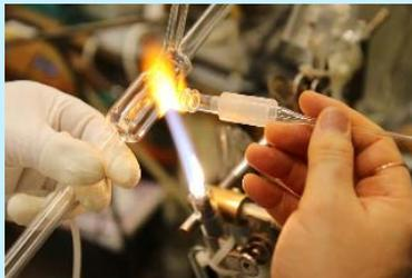
熟練工による微細ガラス加工
