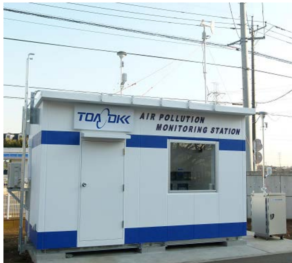
環境大気測定用コンテナ局舎
