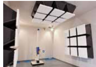
EMC 試験設備
