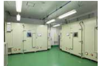
大型環境試験室
